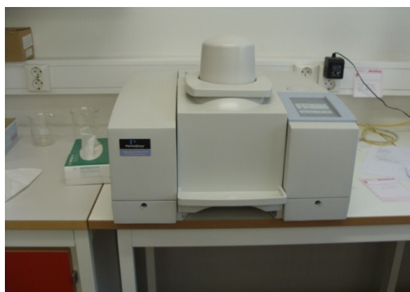
Фиг. 3 Лабораторен спектрофотометър Perkin Elmer Spectrum One NTS, FT-NIR Spectrometer, работещ в диапазона от 700 до 2500 nm.
