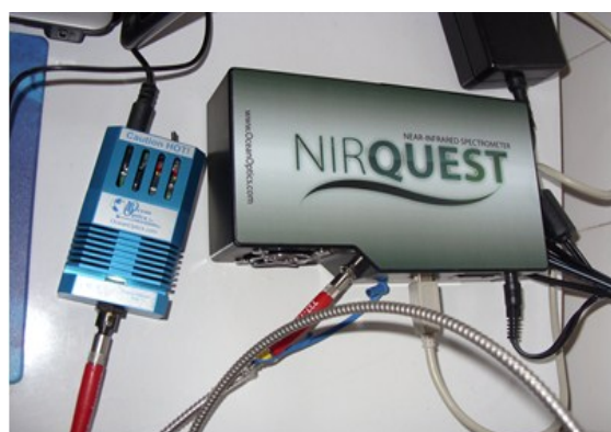
Фиг. 2 NIRQuest 512, работещ в диапазон от 900 до 1700 nm. Портативен модулен спектрофотометър с пробник с оптични влакна.
