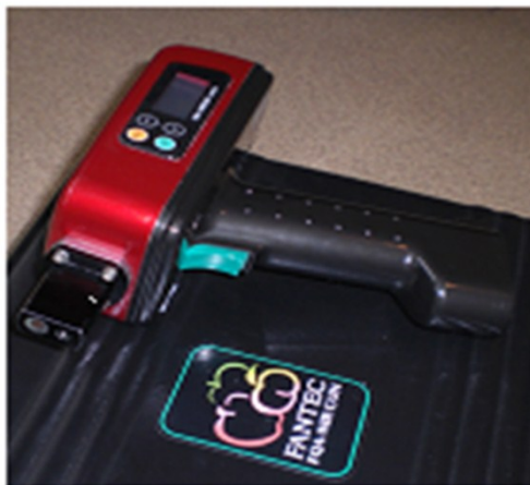
Фиг.1 FQA-NIRGun, FANTEC, Япон, сканиращ спектрофотометър, работещ в късовълновия диапазон 600 -1100 nm.
