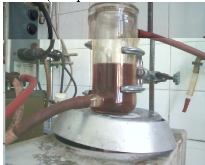
Фигура 5. Експериментална система за изследване поведението на смес от разтвор на конго червено с пентанатриев трифосфат в отсъствие на хитозанови гранули
