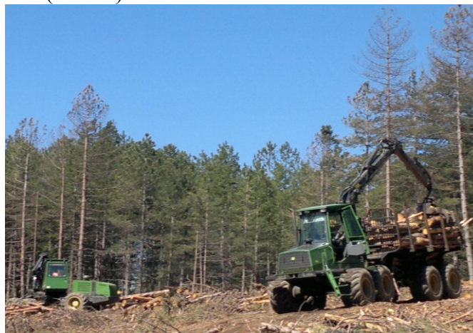
Фиг. 2. Използвана технологична схема с харвестер John Deere 1270D и форвардер John Deere 1110D при дърводобив в България
