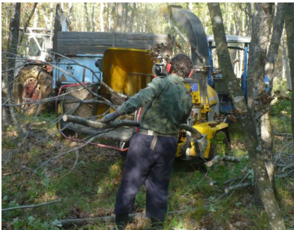
Фиг. 2. Процес на насичане на лесосечните отпадъци в сечището с прикачна секачна машина (частна гора „Ходжа Юрт”)
