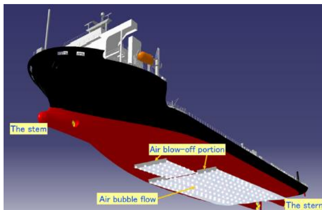
Фиг.4. „Въздушно смазване” на корпусите на корабите.
