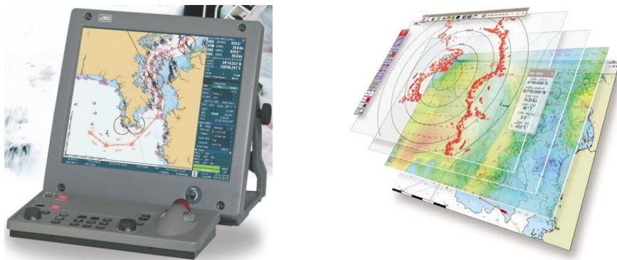
Фиг. 2 – Изглед на ECDIS (Конзола за електронна навигация)
